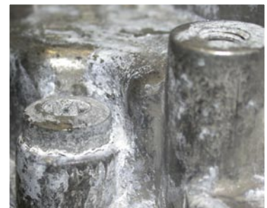
RIBE-Aluform®-Magnesiumgehäuse-Verbindung vor und nach einem 24h Salzsprühnebeltest
