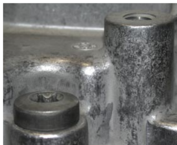
RIBE-Aluform®-Magnesiumgehäuse-Verbindung vor und nach einem 24h Salzsprühnebeltest
