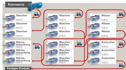
Bis 2009 erfolgte die RIBE® Fertigungsorganisation nach dem Prinzip der Werkstattfertigung
