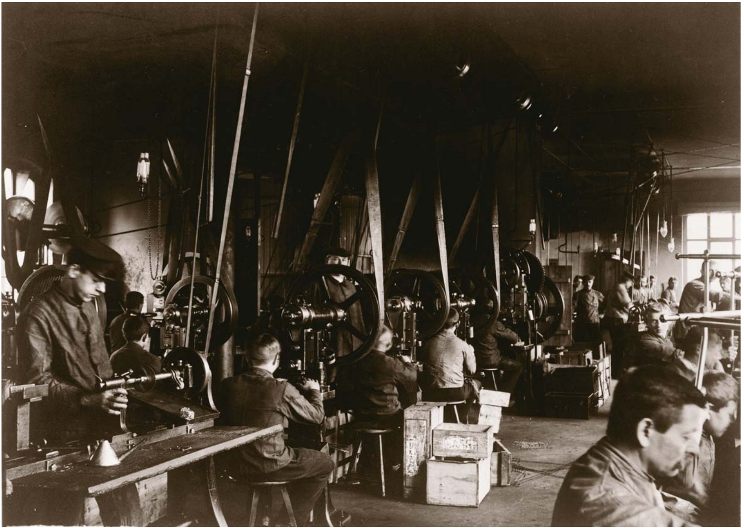
um 1910 Dreherei und Stanzerei im ersten Werk. In der Mitte sitzend, junge Arbeiter an den Stanzmaschinen. Vorne links Arbeiter an einer kleinen Drehbank.
